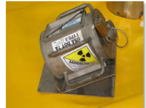
Source scellée de 192 Ir pour gammagraphie (activité max. : 4,9 TBq).
